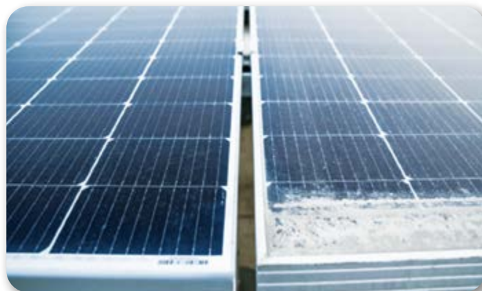
Slika 2: nabiranje umazanije - PV modul brez roba in klasičen PV modul z robom
